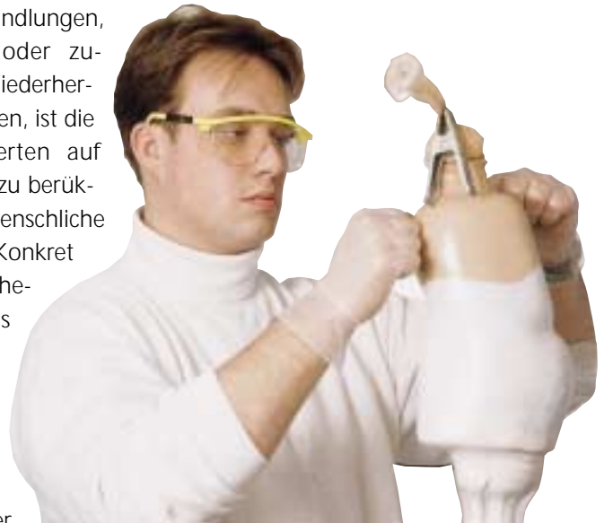
Feinarbeit am Prothesenschaff: Verteilen eines Gießharzgemisches.
